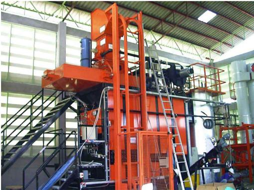
شكل (١٨): آلة ترميد صناعة دانماركية تستخدم النظام الجاف في تنقية الغازات المتصاعدة
